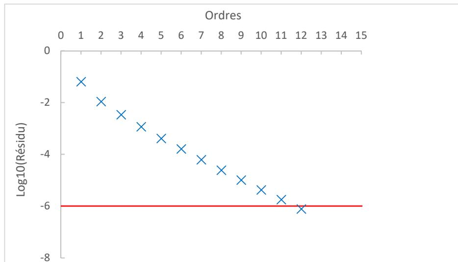
Figure 3 : Evolution du log10 du résidu en fonction de l'ordre de troncature des séries pour le premier mode de vibration de l'exemple de la plaque composite carrée de Litewka et Lewandowski [6] avec  $\tau = 0,016$ ,  $\alpha = 0,52$ ,  $\frac{E_\infty}{E_0} = 2$ . (MNOE).
