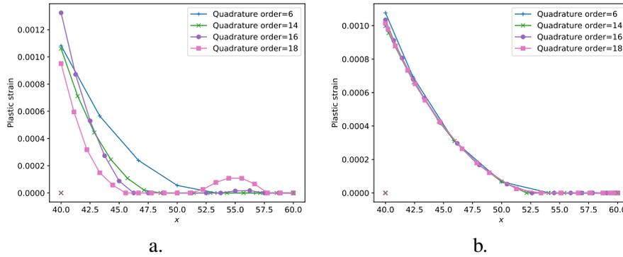
FIGURE 6 – Barre soumise à une force linéique. Déformation plastique dans l’élément central. a. Règles d’intégration moment fitting; b. Règles d’intégration moment fitting positives en utilisant l’approche développée dans cette contribution (cf section 4).
