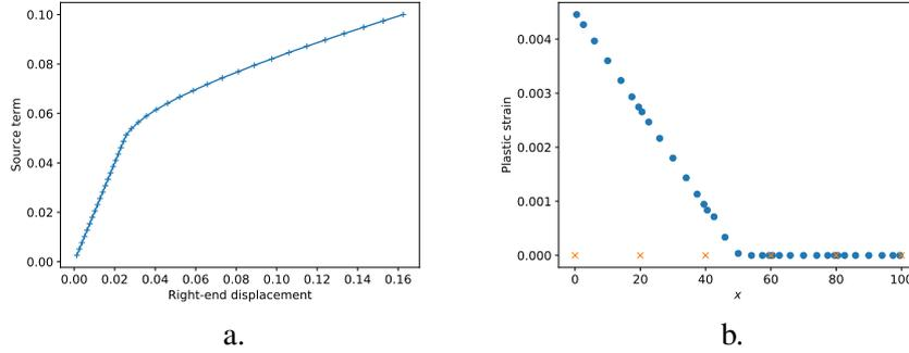
FIGURE 5 – Barre soumise à une force linéique. a. Déplacement de l'extrémité droite en fonction du terme source ; b. Déformation plastique et nœuds du maillage (x).
