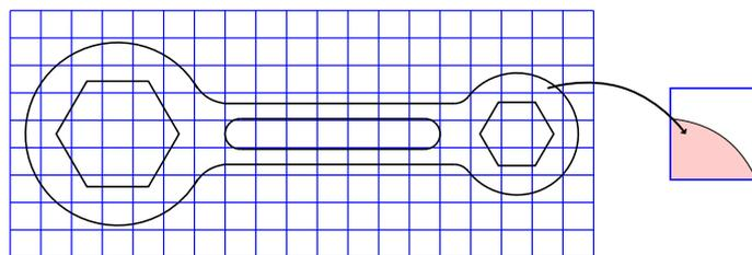
FIGURE 1 – Problème mécanique simulé par une approche de domaines fictifs.
