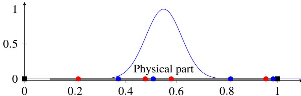
FIGURE 3 – Intégration d’une fonction impulsion sur la partie physique  $[0.1, 1]$  d’un élément  $[0, 1]$ . Les points d’intégration sont représentés par des cercles (rouge : poids positifs, bleu : poids négatifs)
