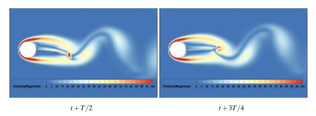
FIGURE 4 – Interaction fluide-structure entre l'écoulement de l'air dans le sillage du cylindre fixe et la poutre flexible. Visualisation sur une période de l'amplitude de la vorticité.
