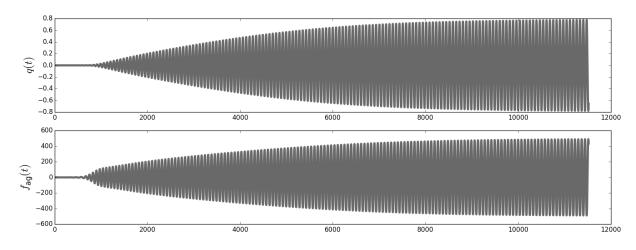
FIGURE 6 – Coordonnée généralisée associée au 1er mode de vibration de la structure (en haut) et effort aérodynamique projeté sur ce même mode (en bas) en fonction des incréments temporels.
