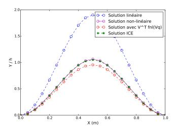
FIGURE 2 – Calcul non-linéaire statique sur la poutre bi-encastrée soumise à un effort vertical au centre de 200N. Comparaison entre un calcul linéaire, un calcul non-linéaire, un calcul réduit (3 premiers modes) avec efforts non-linéaires  $V^T f_{nl}(Vq)$  et un calcul réduit avec efforts non-linéaires d'ordre 3 calculés par condensation implicite (ICE)
