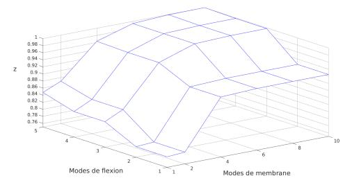
FIGURE 1 – Amplitude relative de la solution obtenue avec le modèle réduit par rapport à la solution haute fidélité pour une poutre bi-encastrée chargée verticalement au centre par un chargement sinusoïdal d'amplitude 50N et de fréquence 35Hz (entre le 1er et le 2ème mode)
