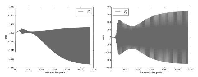
FIGURE 5 – Efforts aérodynamiques s'exerçant sur la poutre en fonction du temps. Efforts intégrés sur la surface, respectivement  $F_x$  à gauche et  $F_y$  à droite.
