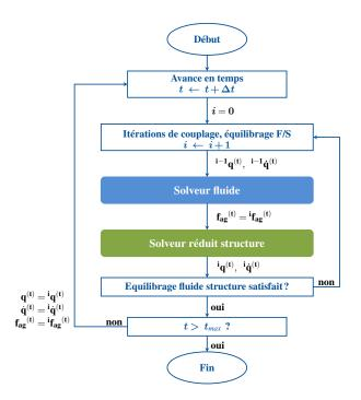
FIGURE 3 – Schéma de couplage partitionné fluide-structure entre le solveur fluide elsA et le solveur non-linéaire réduit structure. On utilise ici la notation  $\mathbf{f_{ag}} = \mathbf{V^T}\mathbf{f_a}$ .
